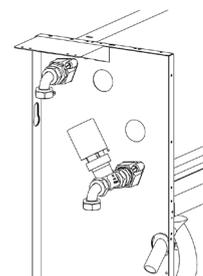
Valvole 3vie con servocomando e kit collegamento e detentore
